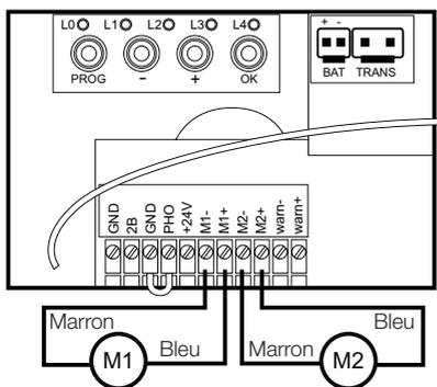
Le moteur qui s'ouvre en premier doit être connecté à la sortie M1 de la carte électronique. (Par défaut, le moteur de gauche est déjà câblé à la sortie M1, modifiez si nécessaire).
