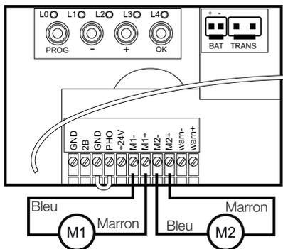
Le moteur qui s'ouvre en premier doit être connecté à la sortie M1 de la carte électronique. (Par défaut, le moteur de gauche est déjà câblé à la sortie M1, modifiez si nécessaire).
