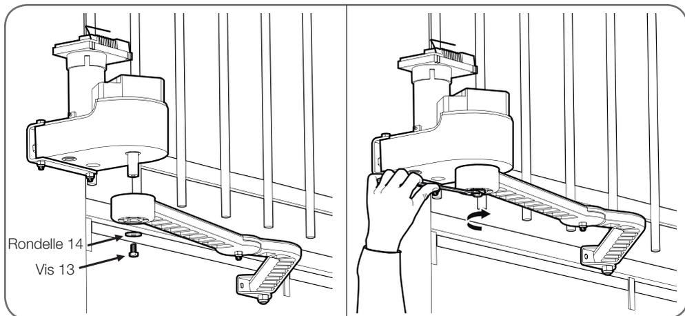
Débrayage du moteur :
