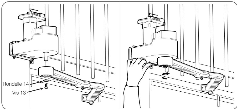
Débrayage du moteur :
