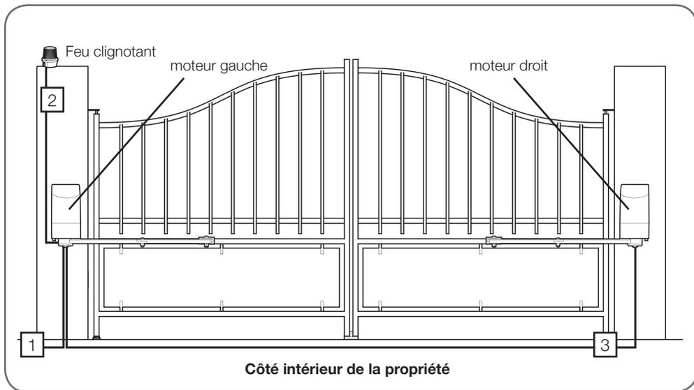
Astuce : si l'arrivée électrique 230V se trouve déjà sur le pilier de droite, il est possible de monter le moteur gauche (qui contient l'électronique de commande) sur le pilier de droite et le moteur droit sur le pilier de gauche. Il suffira d'inverser la polarité de branchement des moteurs pour inverser le sens de rotation par rapport au montage décrit dans cette notice (montage normal avec moteur gauche à gauche et moteur droit à droite).
