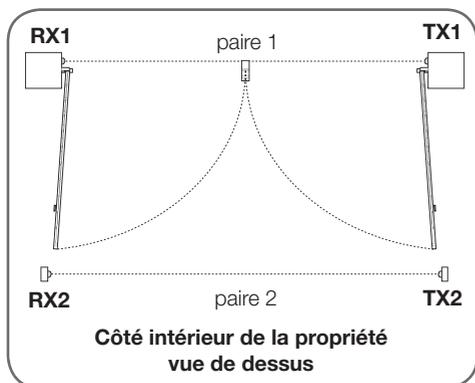
Ainsi, dans un tel cas, le système doit vérifier que son faisceau infrarouge n'est pas coupé avant de commencer à ouvrir les battants. Or par défaut, on ne teste les photocellules que durant la fermeture.
