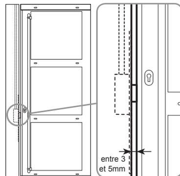
**Attention :** en position porte fermée le téton de la gâche doit être enfoncé par le pêne de la porte.
